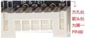
1：此串口可通过硬件调整，配置为 TTL / RS232 的形式与外部设备进行数据连接
