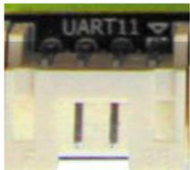
1 : 此串口可通过硬件调整,配置为 RS232 的形式与外部设备进行数据连接.
