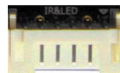
1 : 此默认配置为使用共阴极 LED 灯，如使用的为共阳极灯时，可在制作外接延长线时，将 LED 灯的共同脚接到第 3PIN 上面作为电源输入，注意，此接法后，灯的状态会变，需要软件配置更新。
